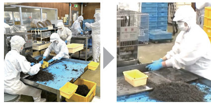
設備の設置角度変更により作業人員が6名→4名になり生産性UP
